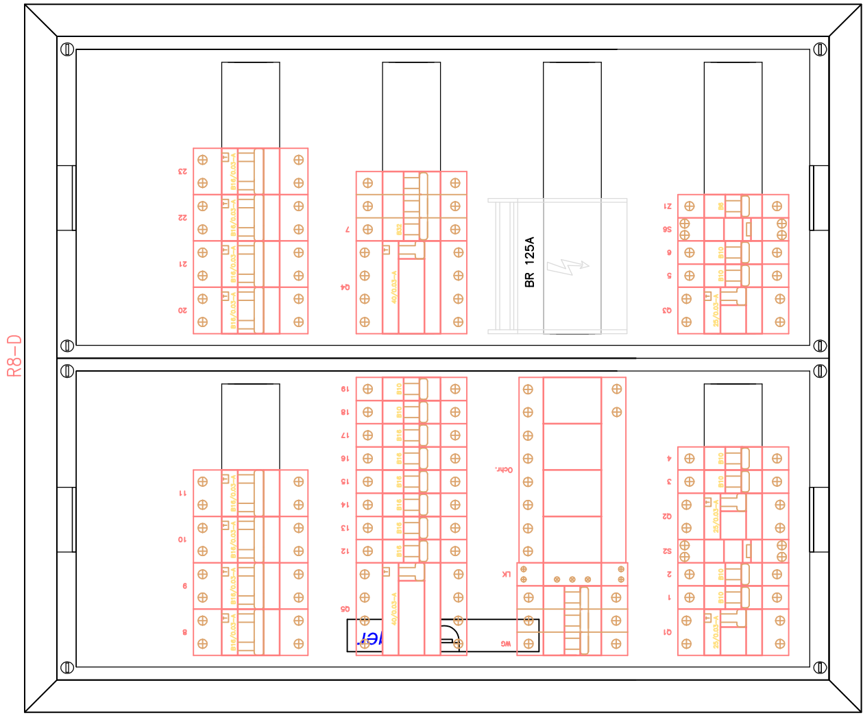
R8-D-rozdzielnica II klasy izolacji IP40, drzwi pełne z zamkiem
